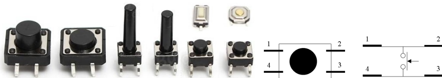
Figura 2.4: Aspeto de vários botões de pressão (esquerda) e representação simplificada (direita).
