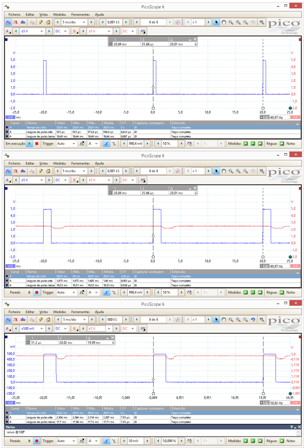
Figura 3.50: Sinais de comando do servo-motor para as posições 0°, 90° e 180°.
