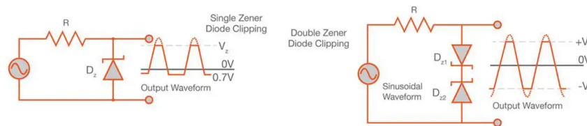
Figura 1.15: Circuito clipping para limitação da amplitude/tensão máxima do sinal à entrada de microfone do telemóvel.
