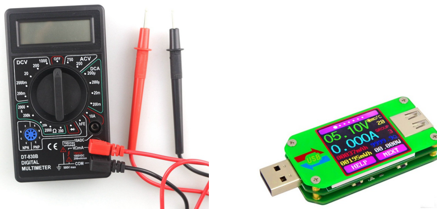
Figura 2.32: Multímetro de uso geral (esquerda) e multímetro para periféricos USB (direita).
