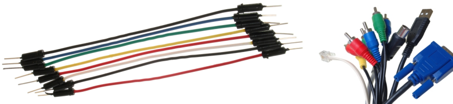
Figura 2.10: Condutores e cabos de diferentes tipos para ligação entre sistemas embebidos e outros periféricos.
