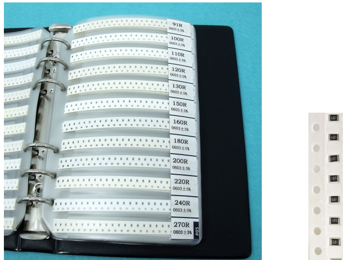
Figura 2.14: Caderno com amostras de todas as resistências de uma série de fabrico (esquerda). Detalhe das resistências de 68\ \Omega (direita).
