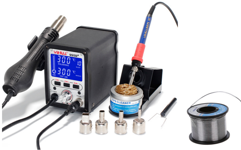
Figura 2.30: Estação de soldadura (esquerda) e rolo de solda (direita).
