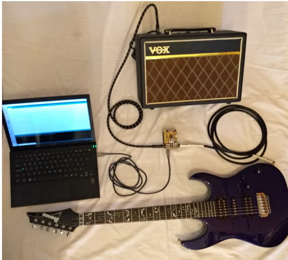
Figura 2.13: Aparato da ligação do Shield de pedal de efeitos de guitarra à guitarra, ao amplificador e ao computador.
