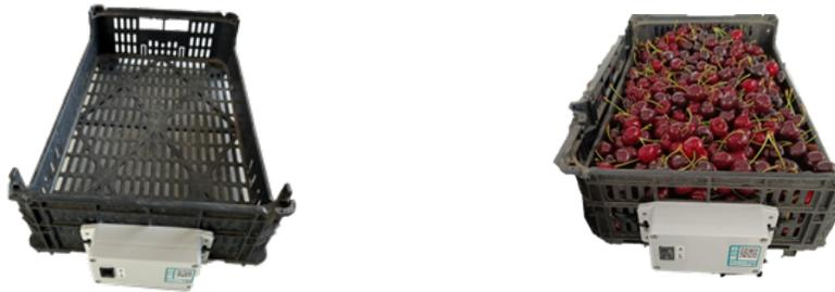
Fig. 1. Caixas de campo com sensores e comunicação com rede LoRa.
